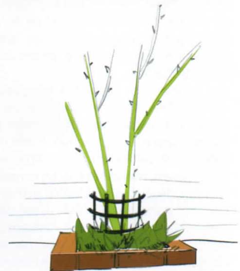
Exemple de protection avec grille métallique et entourage en briques, rectangulaire ou arrondi.
